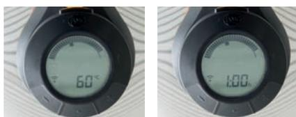
Po uplynutí nastavenej doby varenia sa zapne funkcia udržiavania teploty. To znamená, že váš pokrm sa bude jednu hodinu udržiavať v teple pri teplote 60 °C.
