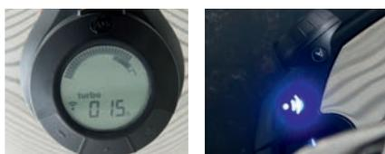
Ak Navigenio bliká namodro a na displeji Audiothermu sa zobrazuje symbol bezdrôtového pripojenia, sú Audiotherm a Navigenio bezdrôtovo spojené. Teplota sa reguluje nezávisle a monitoruje sa čas.
