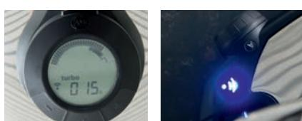
Kada na Navigeniu svjetlo treperi plavom bojom te se na zaslonu Audiotherma prikaže simbol bežične veze, Audiotherm i Navigenio bežično su povezani. Temperatura je pod kontrolom i bit će tijekom cijelog procesa kuhanja.
