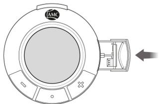
→ Вставьте обратно отсек для батарей в Аудиотерм. Когда отсек щёлкнет, значит он закрылся.
