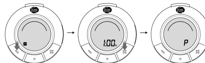
**i** Если время на приборе не введено, то Аудиотерм регулирует температуру приготовления без ограничения по времени. Время приготовления также может быть установлено после начала процесса и может изменяться пользователем по желанию.
