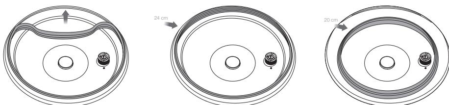
Oval EasyQuick için sızdırmaz contayı (bkz. detay çizimi A) beyaz işaretten yararlanarak yerleştirin
