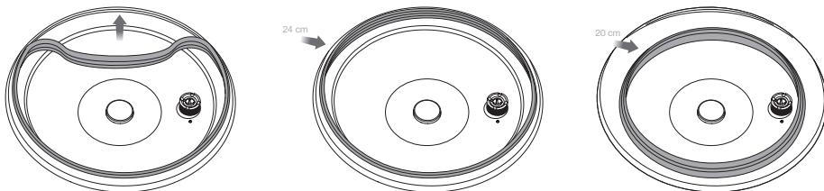
Pour l'Oval EasyQuick, insérer le joint d'étanchéité (voir le schéma détaillé A) à l'aide du repère blanc
