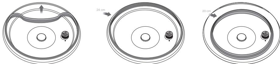
Para el anillo de sellado ovalado de la Tapa Súper-Vapor Oval (ver dibujo detallado A) insertar con la ayuda de la marca blanca
