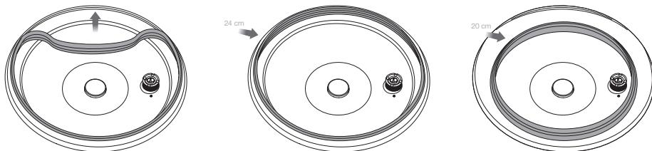
Per EasyQuick Ovale inserire l'anello di tenuta (vedi disegno dettagliato A) con l'ausilio della marcatura bianca
