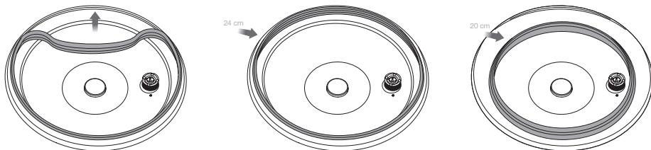
Für Oval EasyQuick Dichtring (siehe Detailzeichnung A) mit Hilfe der weißen Markierung einlegen
