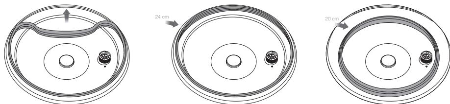
Bij de Oval EasyQuick moet u de sluitring (zie detailtekening A) met behulp van de witte markering aanbrengen.
