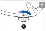
→ Audiotherm auf Visiotherm E setzen, drehen bis Dampf- und Funk-Symbol erscheinen. 6
